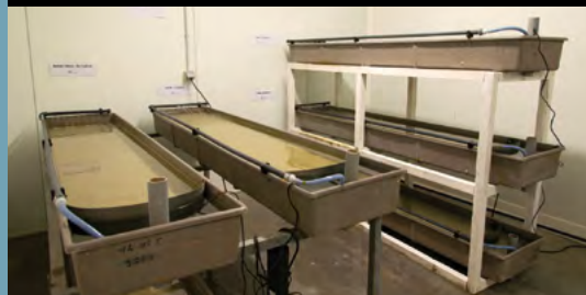
Auges d'élevage remplies de substrat d'aquariophilie et parcourues d'un courant accueillant les jeunes mulettes
