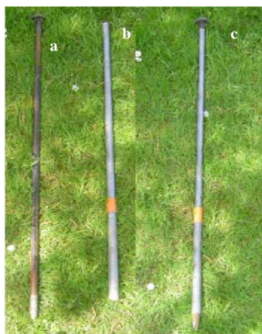
Figure 7. A gauche, stick hypoxie avant utilisation, à droite : a : barre à mine nue, b : tube guide, c : barre à mine introduite dans le guide.
