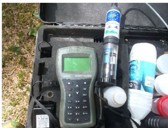
Appareil Hanna HI 9828 permettant de mesurer le pH, la conductivité, l'oxygène dissous et la température
