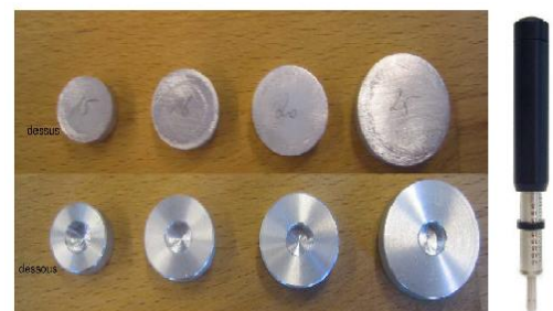
Figure 8 : Disques de diamètre différent réalisés par l'INSA de Rennes (15 mm, 18 mm, 20 mm et 25 mm) et pénétromètre de poche
