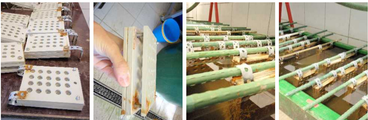
Les plaques Buddensiek (environ 12x20 cm) sont placées soit en circuit fermé, soit en circuit ouvert.
